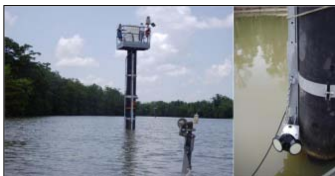
Figura 13. Foto do posto TX (esq.) mostrando o sensor de velocidade (dir.), aqui fora d'água para manutenção.
