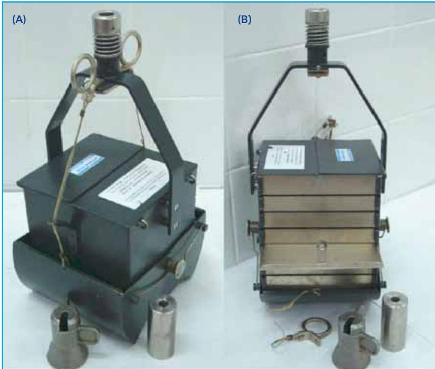
**Figura 22.** Pegador Ekman-Birge, modificado por Lenz: (A) Vista lateral do equipamento montado; (B) Vista frontal do equipamento fechado com fracionador de sedimento inserido (Fotos: César Augusto M. Roda/CETESB).
