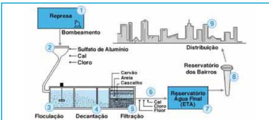
**Figura 84.** Esquema de um sistema de produção e distribuição de água. – Fluxo operacional: (1) Manancial de abastecimento; (2) Aplicação de produtos químicos; (3) Sistema de Floculação; (4) Sistema de decantação; (5) Sistema de filtração; (6) Aplicação de cloro, flúor e cal; (7) Reservatório da ETA; (8) Reservatório elevado; (9) Rede de distribuição (Fonte: CETESB, 2009).
