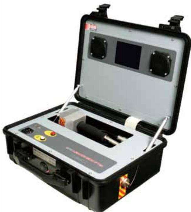
O SF6 LeakCheck P1:p é uma revolução na detecção de vazamento SF6, garantindo uma busca incrivelmente rápida em níveis ultrasensíveis. Mesmo o menor dos vazamentos pode ser detectado e localizado rapidamente com um nível de detecção de  $1 \times 10^{-7}$  ml/seg. ou o opcional de  $1 \times 10^{-8}$  ml/seg., equivalente a um grão de arroz por ano!
